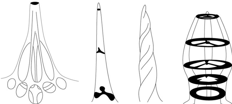
SOLID SPINE REINFORCED BY BASAL SUPPORTS    THREE BLADED SPINE    SPIRAL SPINE    SPECIAL (INFLATED) SPINE
