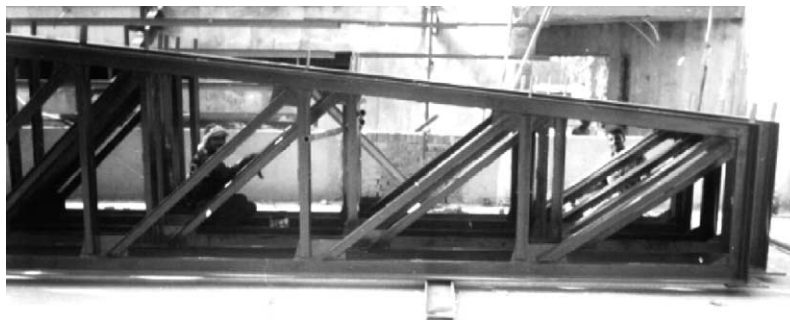
Fig. 1. Photo of actual N-shaped truss.
